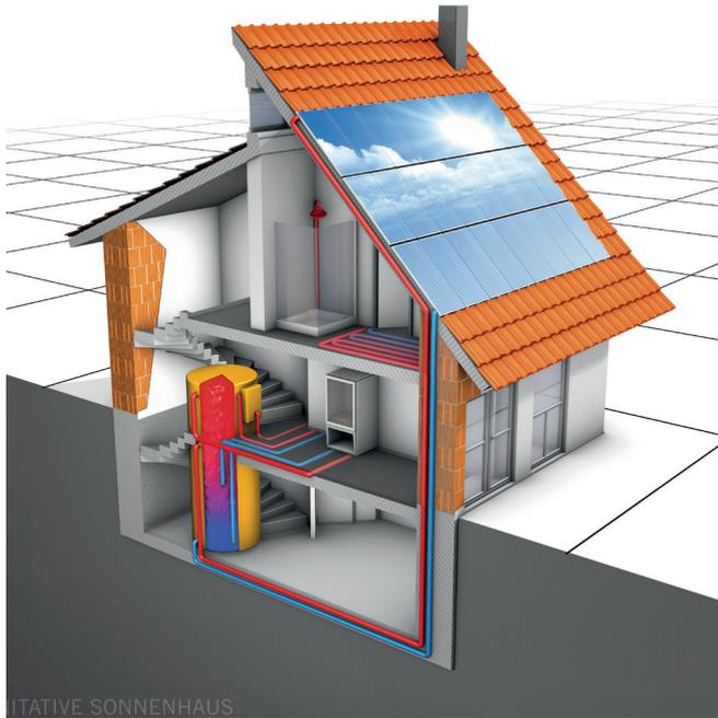
Die Wärme aus den **thermischen Sonnenkollektoren** wird direkt in den **Bauteilen – Wände, Bodenplatte, Decke** und in einem **kleinen (1,5 m<sup>3</sup>) Pufferspeicher** – gespeichert. **Hygienische Warmwasserbereitung** in einer **Frischwasserstation**. Die Nachheizung erfolgt mit **Biomasse** (Pellets oder Scheitholz im Keller oder Wohnraum). Zusätzlich kann eine **PV-Anlage mit oder ohne Batterie** den **Haushaltsstrombedarf** decken.
