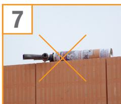
**Nach Gebrauch:** Pistole mit Schaum gefüllt lassen (nicht leer schäumen) und immer eine gefüllte Dose auf der Pistole lassen. Stellschraube gut zudrehen. Dose aufrecht wegstellen (Pistole nach oben).
