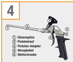
**Inbetriebnahme:** „klimabloc DRYFIX extra System“-Dose ca. 20 x schütteln (vor jedem Gebrauch) und auf den Pistolen-Adapter schrauben (nicht zu fest). Nun die Stellschraube aufdrehen und Abzugshebel mind. ca. 2 Sekunden drücken (Füllen des Pistolenlaufs) und Kleber kurz ausströmen lassen (Karton o.ä.). Der Kleberaustritt wird mit dem Abzugshebel reguliert und kann mit der Stellschraube begrenzt werden.
